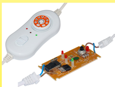
2019 Unità di controllo della coperta con controllo elettronico continuo della potenza (Ultimheat Collection)
