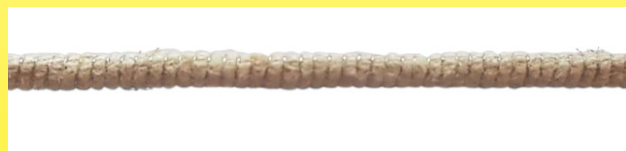
1960 ca. Cavo scaldante Calor, diametro 1.7 mm, filo scaldante singolo al nichel-cromo, diametro 0.08 mm, su un'anima di cotone leggermente attorcigliato per evitare che si pieghi. (Ultimatheat collection)
