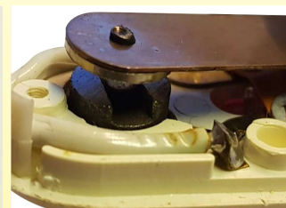
1972 ca. Centralina di controllo della potenza prodotta da Jidé a Limoges con il marchio Jidéstat. Il sistema di maggior successo. Di dimensioni molto ridotte, è regolabile e incorporata nella spina elettrica. È l'unico modello con contatto magnetico a scatto. È stato superato dai sistemi elettromeccanici solo nell'era attuale. (Ultimheat Collection)
