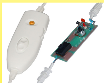
2019 Unità di controllo della coperta con controllo elettronico continuo della potenza (Ultimheat Collection)
